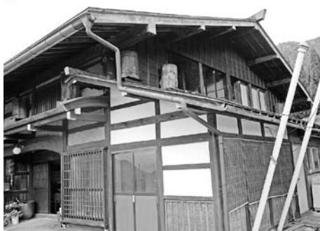
飛騨に多く見られる養蚕農家(飛騨市古川町数河地区)。(上・正面)間口8間の大型の建物で、平入り。1階と2階の間に底を持つ(下・妻側)屋根は切り妻。緩やかな勾配は樽板葺きの名残りで、今は垂鉛葺き。長い軒は風雨や雪から蚕を守る
